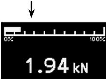
Der Belastungsanstieg wird in der Messanzeige dargestellt. Eine Nenn-Belastungsgeschwindigkeit wird angewendet, bis eine Kraft von 250 N (56 lbf) erreicht ist. An diesem Punkt wird für die Dauer des Tests die programmierte Belastungsgeschwindigkeit angewendet.
