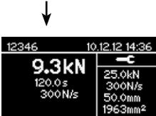
Nach Abschluss der Prüfung werden in der Messübersicht Belastungsspitze, Prüfdauer und die tatsächliche Belastungsgeschwindigkeit angezeigt. Der Motor macht sich automatisch für die nächste Prüfung bereit.
